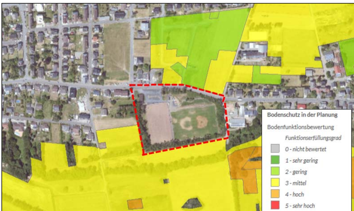
Abb. 2: Bewertung auf Grundlage der Bodenfunktionsbewertung; Plangebiet: rot umrandet. (Quelle: BodenViewer Hessen, Zugriffsdatum: 11/2023, eigene Bearbeitung)
